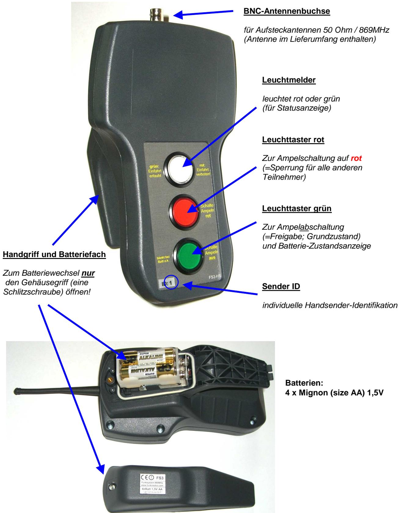
Das Hauptgehäuse (6 Kreuzschlitzschrauben) braucht vom Anwender **niemals** geöffnet werden!
