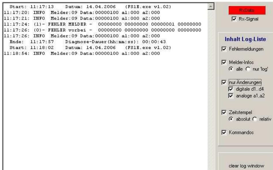
Im Log-Fenster können alle Nachrichten (siehe Kapitel 3.13), welche der FS1E ausgibt angezeigt werden. Um die Daten übersichtlich und die Dateigröße möglichst gering zu halten, kann der Umfang der ausgewerteten Information mit den Schaltern unter „Inhalt Log-Liste“ eingestellt werden:
