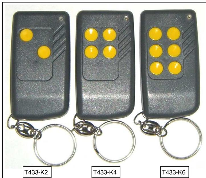
Diese Handsender für 433,92 MHz sind kompatibel zu den programmierbaren IS16-Industriesendern mit 433,92 MHz und können somit parallel zu diesen als lowcost-Taschenvariante betrieben werden (mit eingeschränktem Funktionsumfang, verglichen zu den IS16-Derivaten). Darüberhinaus können Sie durch die flexible Programmierung als Ersatz für zahlreiche andere Sender mit 1/3-2/3 ASK –Codierung bei 433,92MHz verwendet werden.
