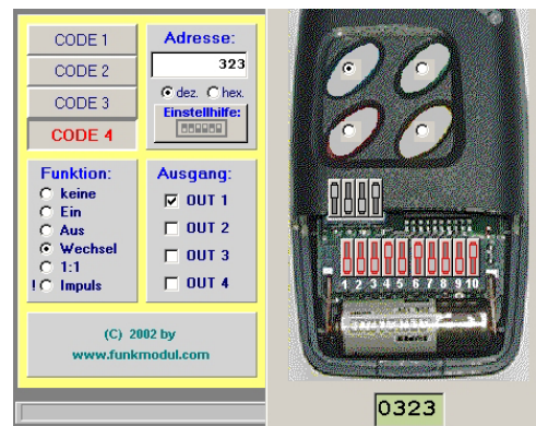
Konfiguration für Taste links oben (Wechselschalterfunktion auf out 1)
